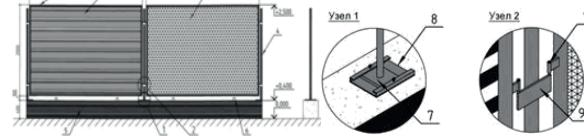
Узел 1 – крепление стойки к бетонному блоку; Узел 2 – крепление панелей к стойке.
